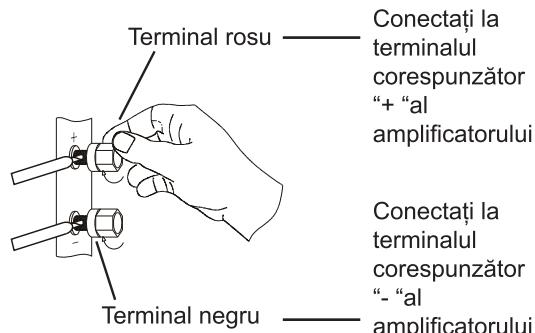
Conectați la terminalul corespunzător “+” al amplificatorului
