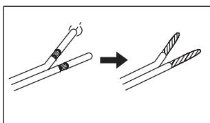
2. Anschlussklemme gegen den Uhrzeigersinn drehen und Kupferkabel in das Loch einstecken.
