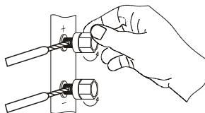
3. Anschlussklemme im Uhrzeigersinn anziehen, leicht am Kabel ziehen um sicherzustellen dass die Verbindung fest ist.
